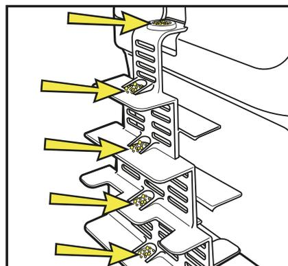
8. Stellen Sie die Falle an einem Mäusepfad entlang einer Wand auf und legen Sie die Leiter an die Wand. Die Falle muss auf einer waagerechten Fläche aufgestellt werden (achten Sie darauf, dass die Luftblase in der Mitte steht).
